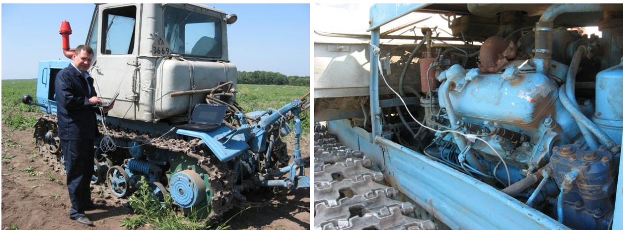
Рис. 6. Установлення й закріплення датчиків прискорень на випробуваному тягово-транспортному засобі
