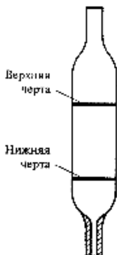
Рис 1. Піпетка для визначення ступеня гомогенізації молока
