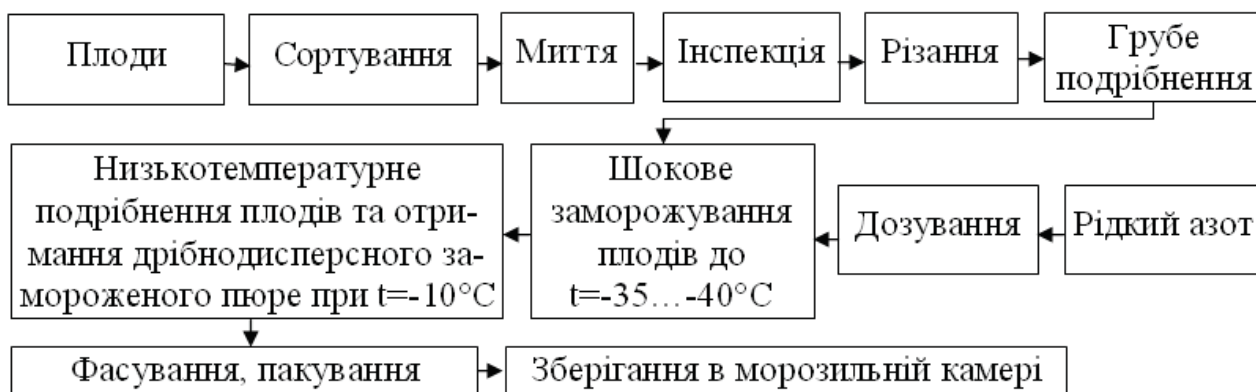
Рис. 2. Технологічна схема виробництва заморожених дрібнодисперсних добавок у формі наноструктурованих пюре з плодів з використанням криогенного заморожування та низькотемпературного подрібнення
