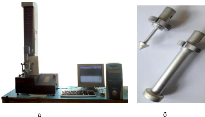
Рис. 1. Універсальна випробувальна машина SANS CMT2503: а – загальний вигляд; б – індентор Magness-Teaylor та індентор у вигляді циліндричного плунжера
