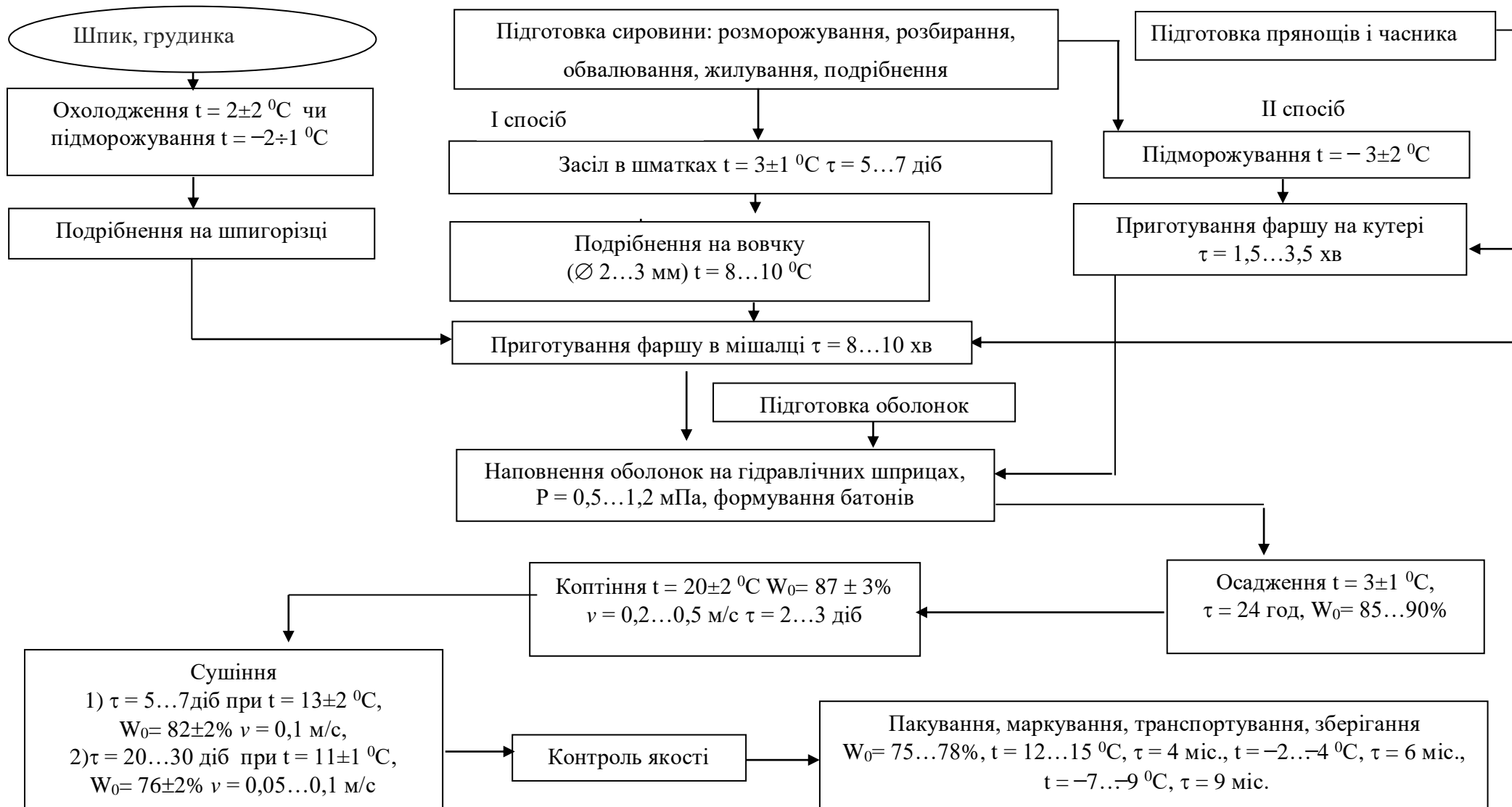
Рисунок 2.6 – Технологічна схема виробництва сирокочених ковбас
