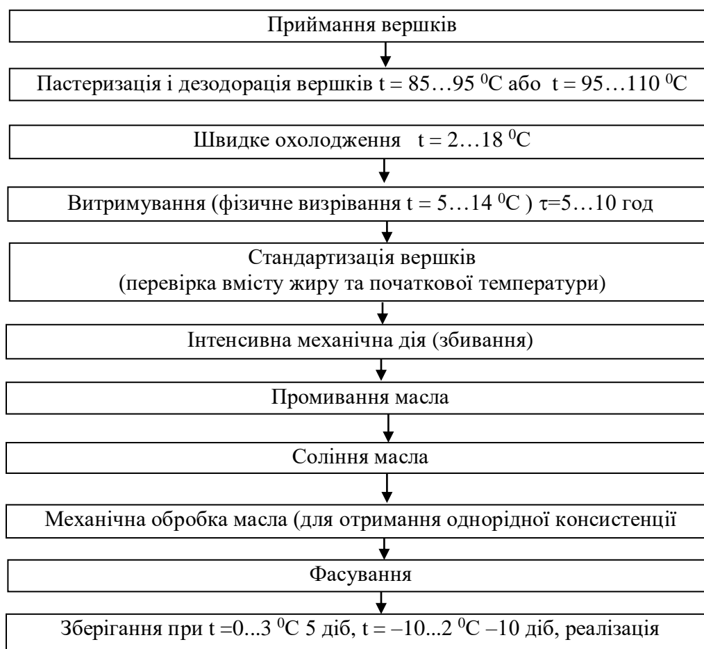
Рисунок 3.16 – Принципова технологічна схема виробництва масла вершкового методом збивання
