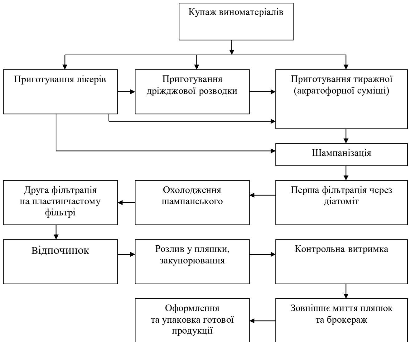
Рисунок 8.5 – Принципова технологічна схема виробництва шампанського резервуарним способом
