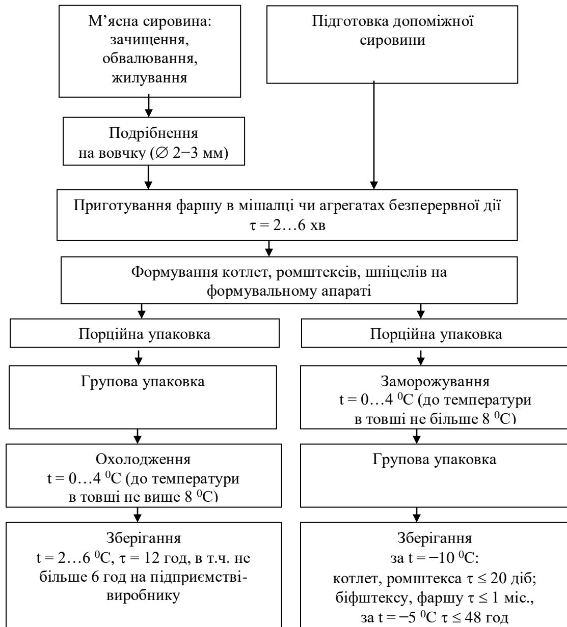
Рисунок 2.11 – Технологічна схема виробництва січених напівфабрикатів із м'ясної сировини
