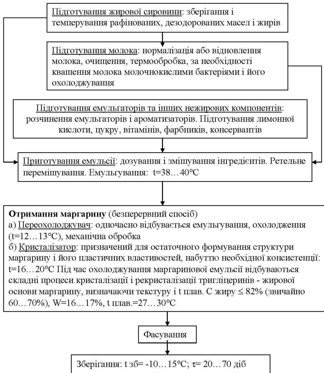
Рисунок 9.5 – Технологічна схема виробництва маргарину
