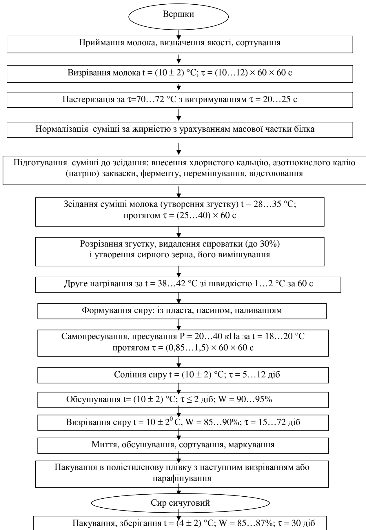
Рисунок 3.27 – Загальна технологічна схема виробництва сирів сичугових
