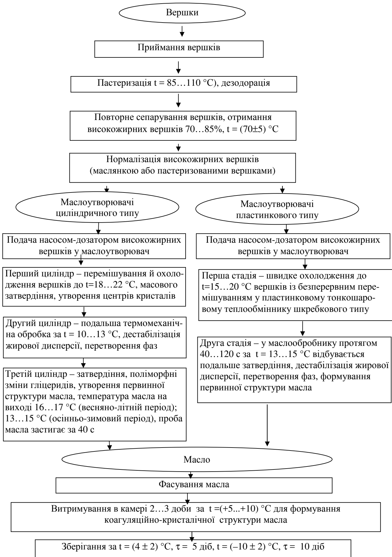
Рисунок 3.25 – Технологічна схема виробництва масла перетворенням високожирних вершків
