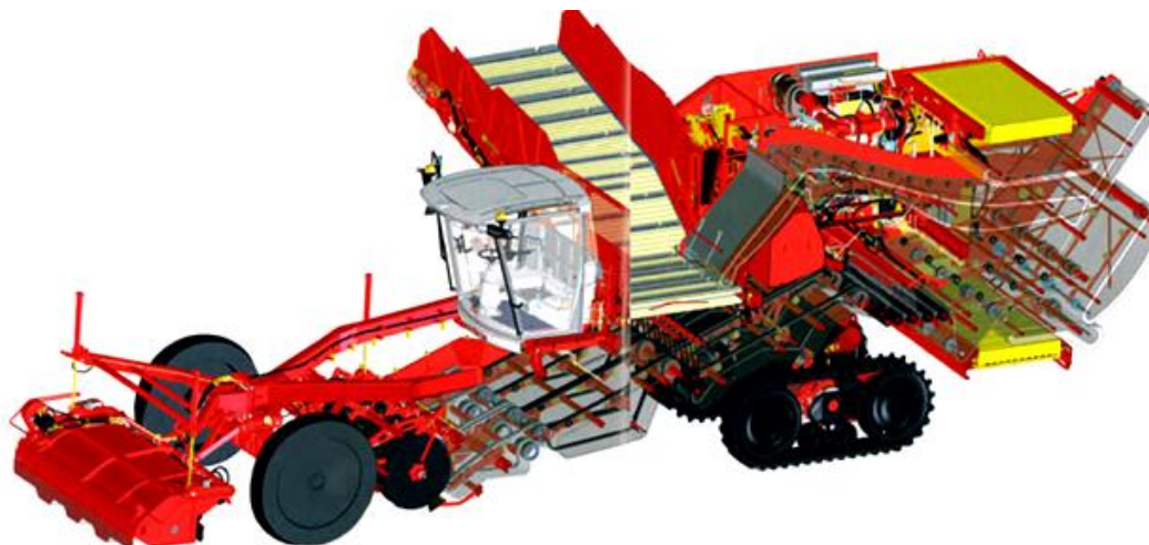
Рис. 8 – Технологічна схема роботи картоплезбирального комбайна Grimme VARITRON 470
