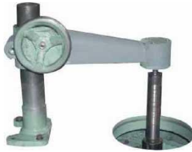
Рисунок 14.4. Фіксація оправлення кронштейном
