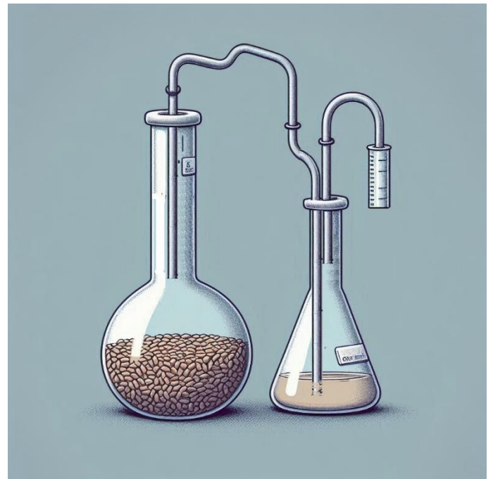
Рис. 2.1. - Лабораторна установка для вимірювання інтенсивності дихання зерна
