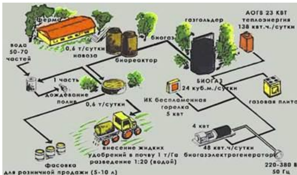
Рис. 10.1. Принципова технологічна схема переробки органічних відходів
