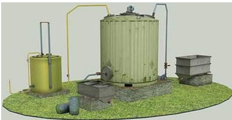
Рис. 10.2. Стандартний біореактор на 6 м 3 в центрі, газгольдер – зліва
