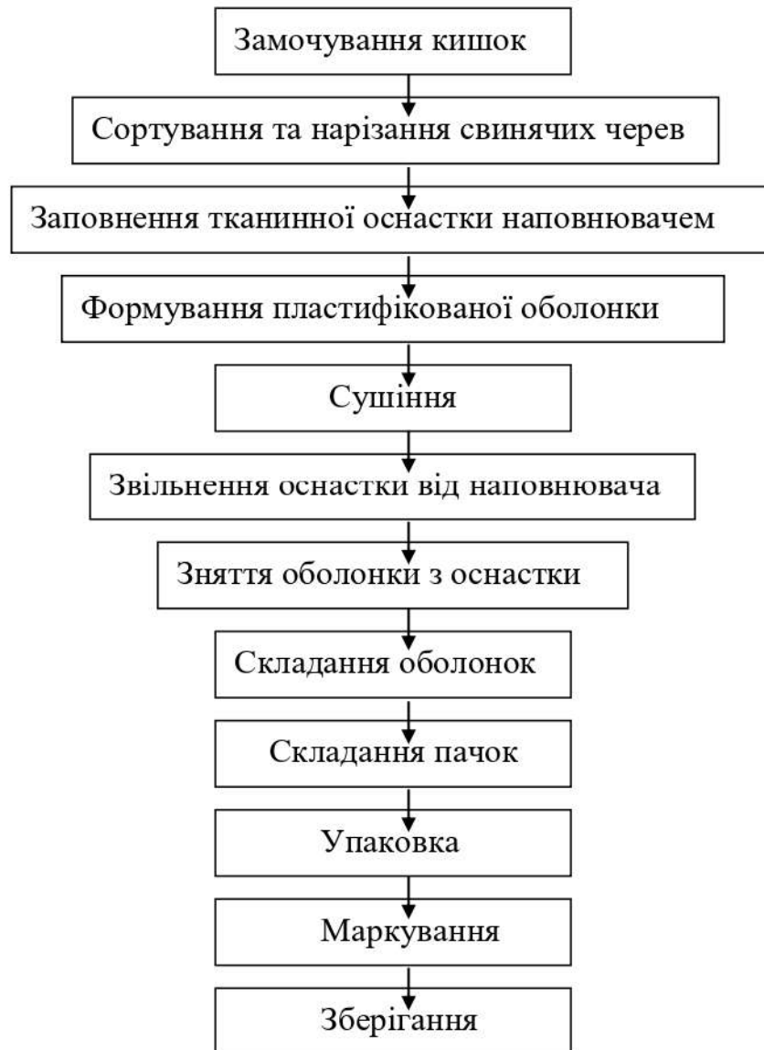
Рисунок 1.5 – Принципова технологічна схема виробництва склеєних оболонок
