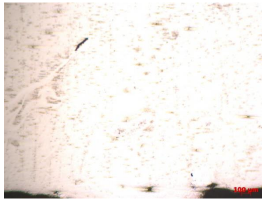
Рисунок 3.7 – Неметалеві включення в покритті відновленого шару електродом Т-620 з модифікуванням глиною, \times 200
