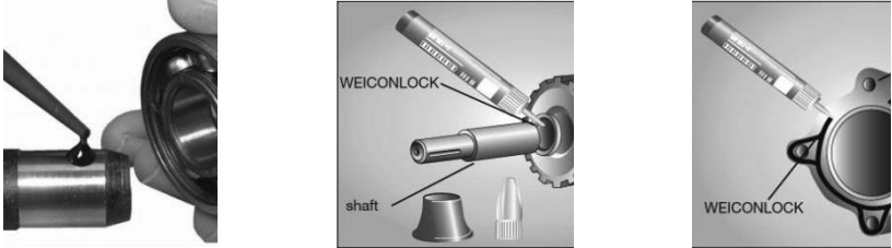
Рис. 3.65 – Схема застосування анаеробних клеїв для посадочних місць
