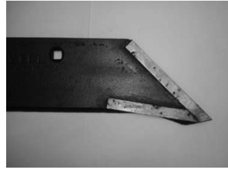
Рис. 5.22 – Леміш, відновлений і зміцнений припаюванням пластин: а – лицьова сторона леміша; б – тильна сторона леміша; в – носок леміша
