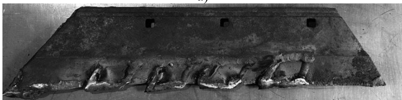
Рис. 5.31 – Леміш з вставками, що компенсують, (а) та додатковим зміцненням тильної сторони вставок (б) електродом Т-590
