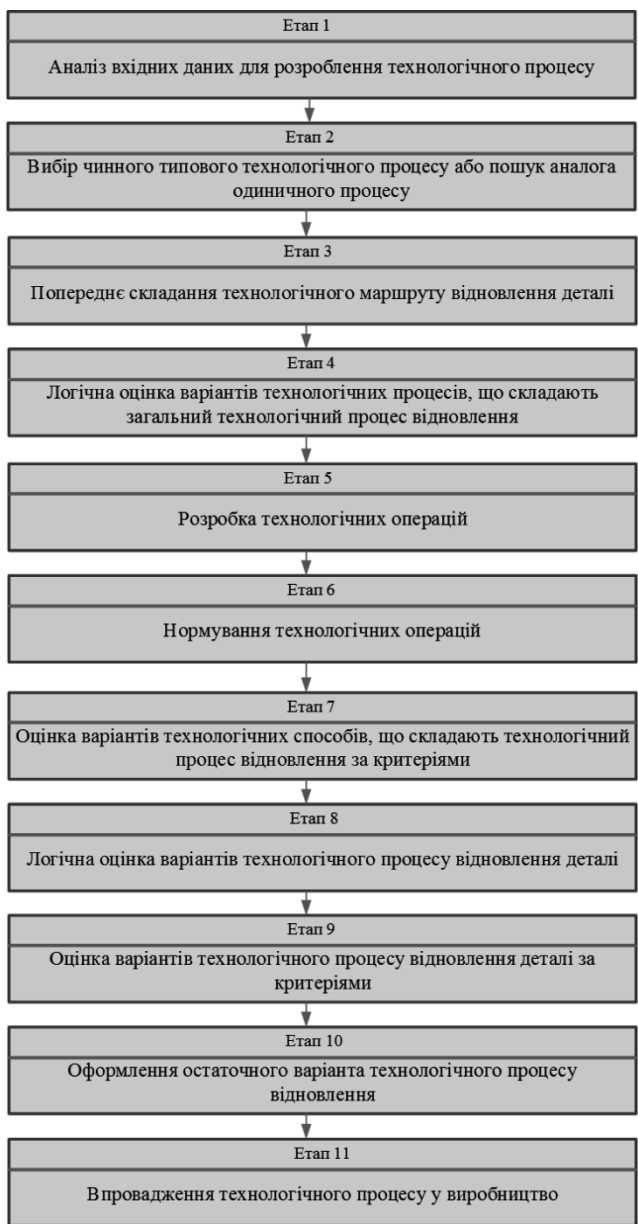
Рис. 4.2 – Основні етапи проектування технологічного процесу відновлення
