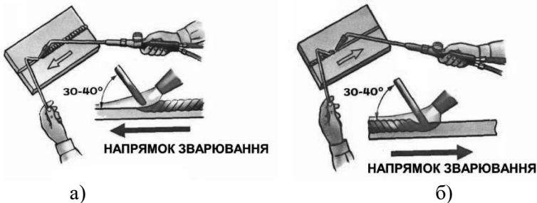
Рис. 3.6 – Способи газового зварювання: а – лівий; б – правий
