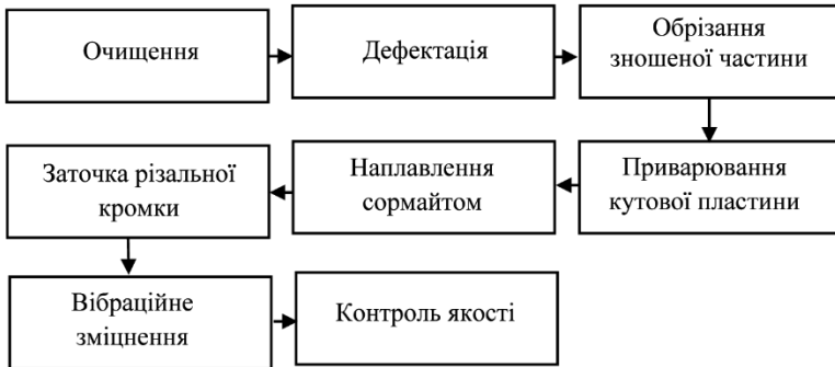
Рис. 5.36 – Схема технологічного процесу відновлення та зміцнення стрічастих лоп культиватора
