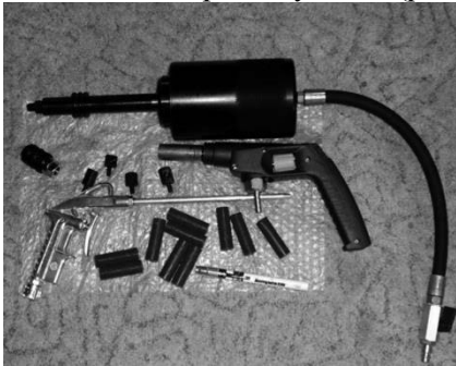
Рис. 3.69 – Комплект приладів безрозбірного ремонту кульових з'єднань
