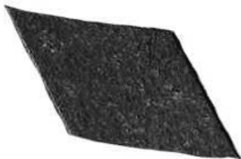
Рис. 5.28 – Фрагмент відпрацьованого ресорного листа автомобіля
