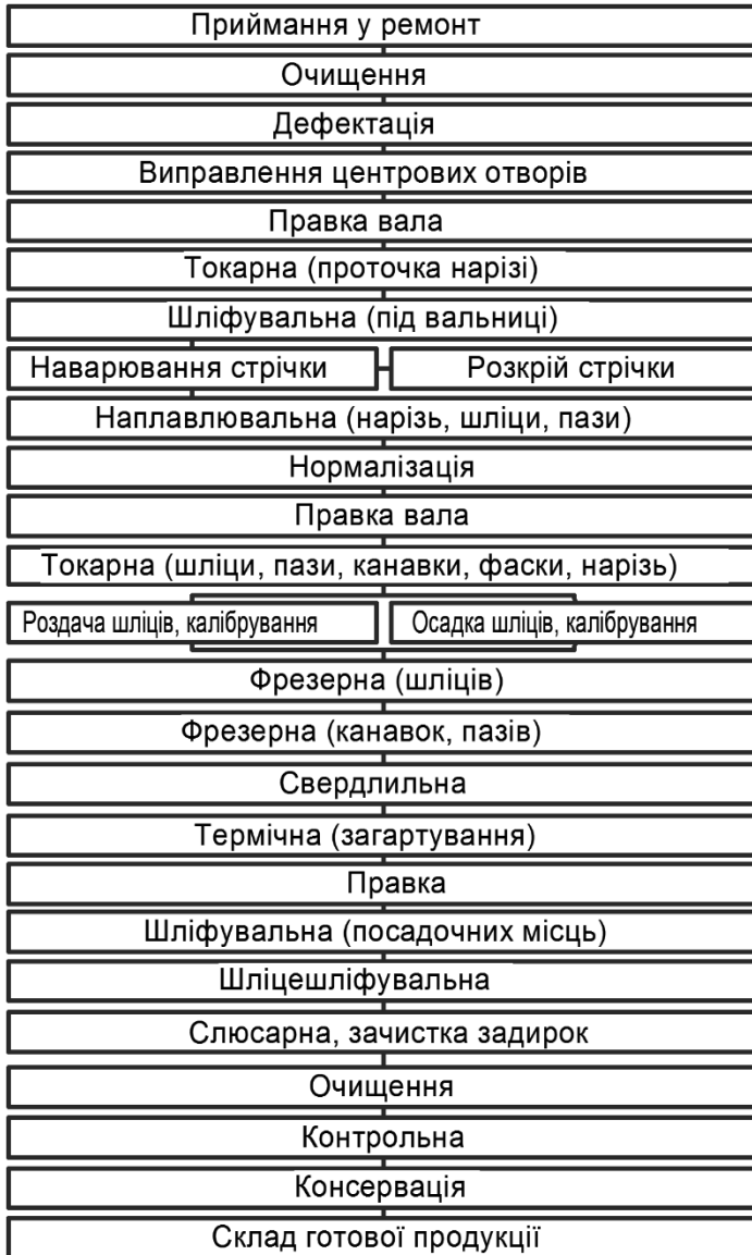
Рис. 5.17 – Схема технологічного процесу відновлення шліцьових валів
