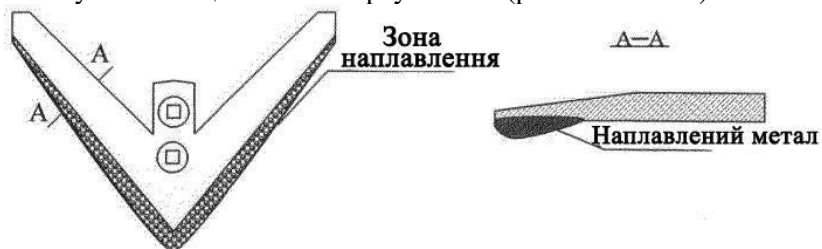
Рис. 5.33 – Лапа з навареним запасом металу з тильної сторони
