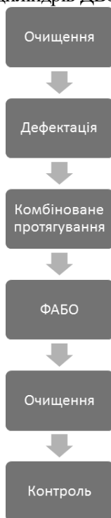
Рис. 5.11 – Структурна схема технологічного процесу відновлення гільз циліндрів ДВЗ в I ремонтний розмір
