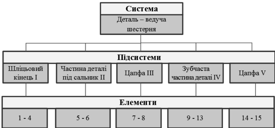
Рис. 1.4 – Схема ієрархічної структури деталі
