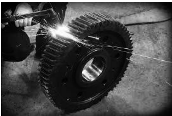
Рис. 5.15 – Наплавлення зношених зубців шестерень
