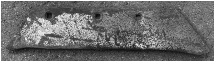
Рис. 5.26 – Загальний вид зношених лемішів
