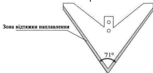
Рис. 5.33 – Лапа з навареним запасом металу з тильної сторони
