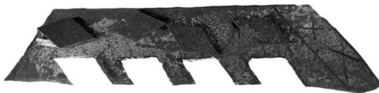
Рис. 5.29 – Поверхня лемішу з вирізами під вставки
