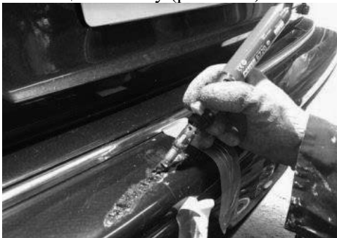
Рис. 3.80 – Паяння пластикових деталей за допомогою нагрівальних елементів
