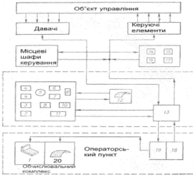
Рисунок – Структура технічного забезпечення: 1 – пульт програміста; 2 – цифрове табло; 3 – задавач; 4 – показуючі прилади; 5 – сигнальні табло; 7 – цифрові прилади; 8 – самописці; 9 – мнемонічна схема; 10 – ключі керування; 11 – клавіатура; 12 – аналогова машина; 13 – кросова шафа; 14 – вимірювальні прилади; 15 – регулятори; 16 – підсилювачі; 17 – самописці; 18 – пристрій керуючої системи ЕОМ; 19 – інформаційна система ЕОМ; 20 – принтер
