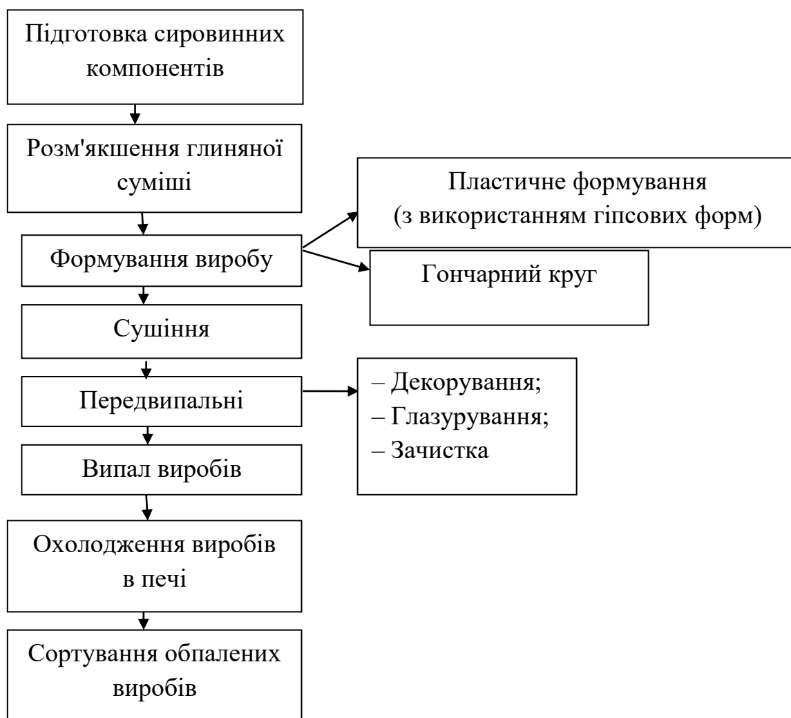
Рисунок 1.7 – Технологічна схема виробництва керамічних горщиків для квітів
