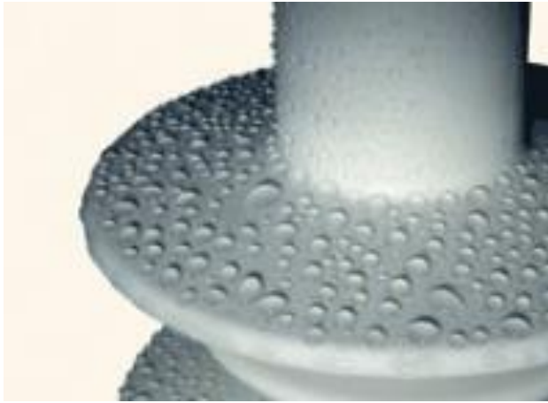
Рисунок 10 – Взаємодія води з поверхнею полімерного ізолятора
