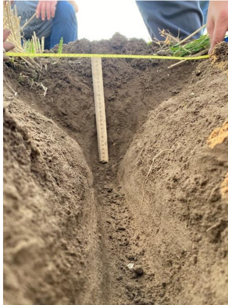
Рис. 5. Геометричні параметри профілю обробленої смуги. Київська область.
