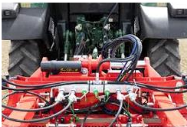
Рис. 4. Культиватор для міжрядного обробки ґрунту FLEXCARE V австрійської компанії RÖTTINGER: a – у складі агрегата в роботі; б – загальний вигляд; в – обладнання системи автоматичного паралельного водіння
