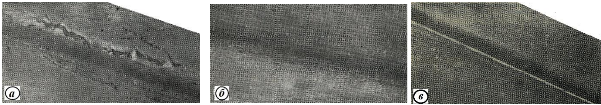
Рис. 8. Місце згину стінки коритоподібного профілю виготовленого без поперечного стиснення та обтиснення по товщині (а), з поперечним стисненням (б) та зі стисненням та обтисненням по товщині (в)
