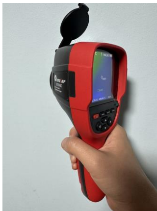
Рис. 2. Зовнішній вид тепловізора TOOLTOP ET692C
