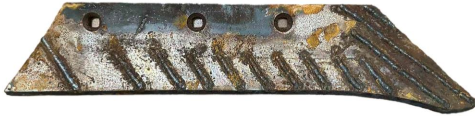
Рис. 4. Зміцнений бар'єрними валиками новий леміш
