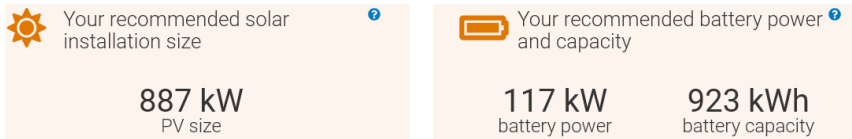
Рисунок 13 – Рекомендований розмір сонячної установки, потужність і ємність акумулятора
