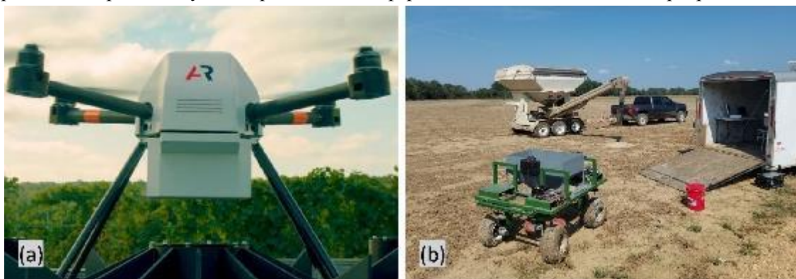
Рисунок 1 – БПЛА «Скаут» від American Robotics (а); робот для розкидання насіння, боротьби з бур'янами та відбору проб ґрунту (б)
