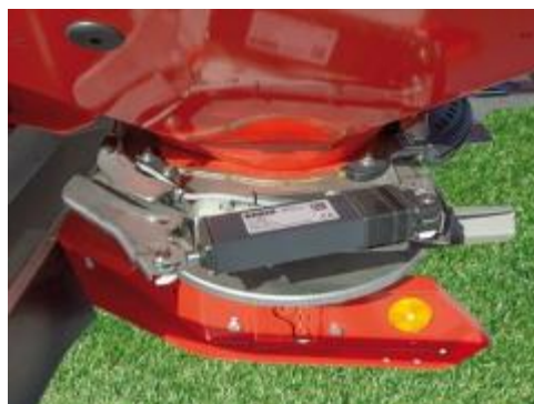
Рис. 2. Дозуючий пристрій розкидача
