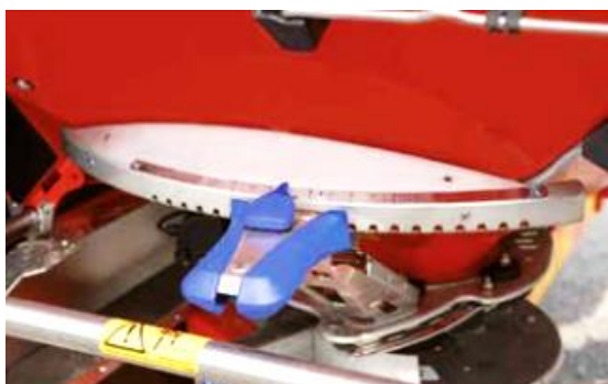
Рис. 3. Ручне регулювання точки подачі добрив
