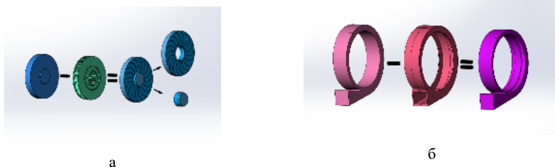
Рис. 1. Логічне віднімання об'єму повітряного потоку з об'єму вузла, що спостерігається для створення моделі: а – робочого колеса; б – спіральний корпус равлика.
