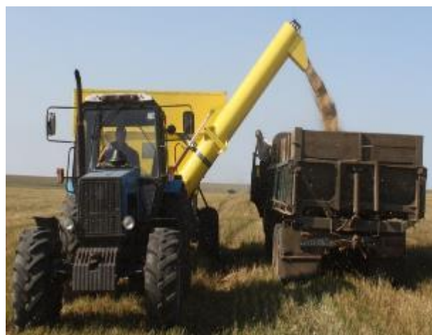
Рис. 2. Завантаження транспортного засобу із бункера – накопичувача
