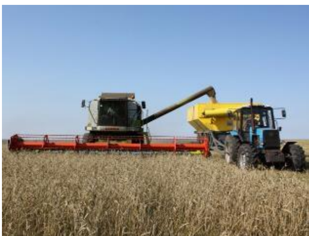
Рис. 1. Розвантаження бункера комбайна в бункер – накопичувач
