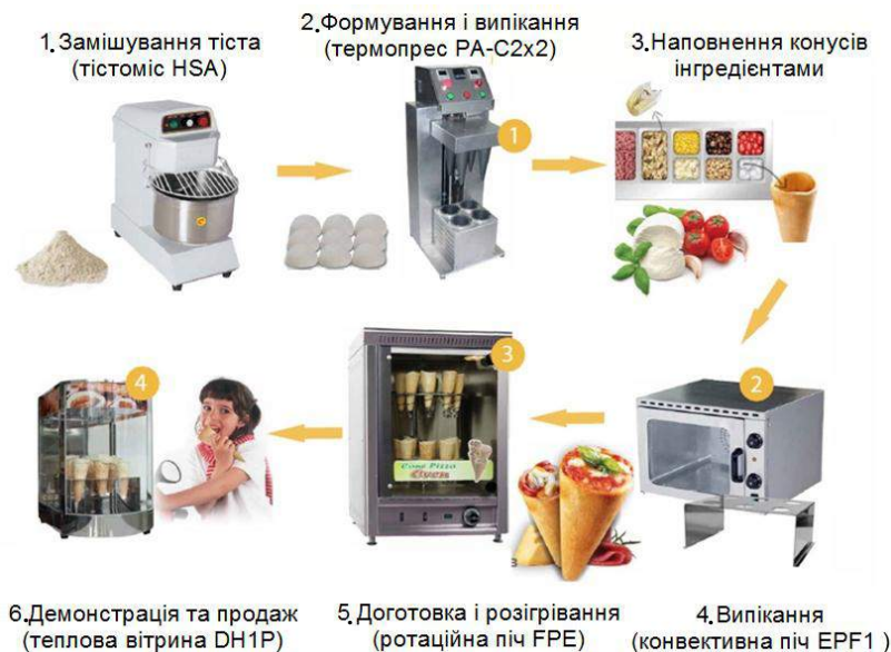
Рисунок – Технологічний процес приготування конопіци та варіант підбору устаткування
