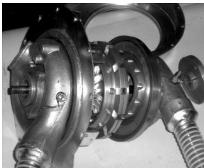
Рисунок 1 – Ротор пульсувального апарата для гомогенізації молока
