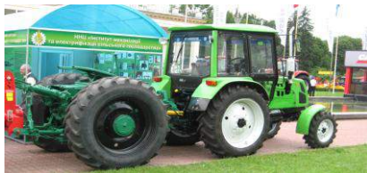
Рисунок 5 – МЕЗ змінного тягового класу 1,4-3
