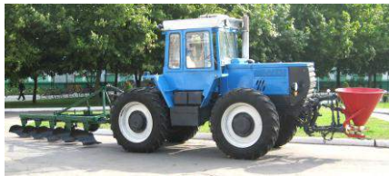
Рисунок 6 – Комбінований МТА на основі ХТЗ-160
