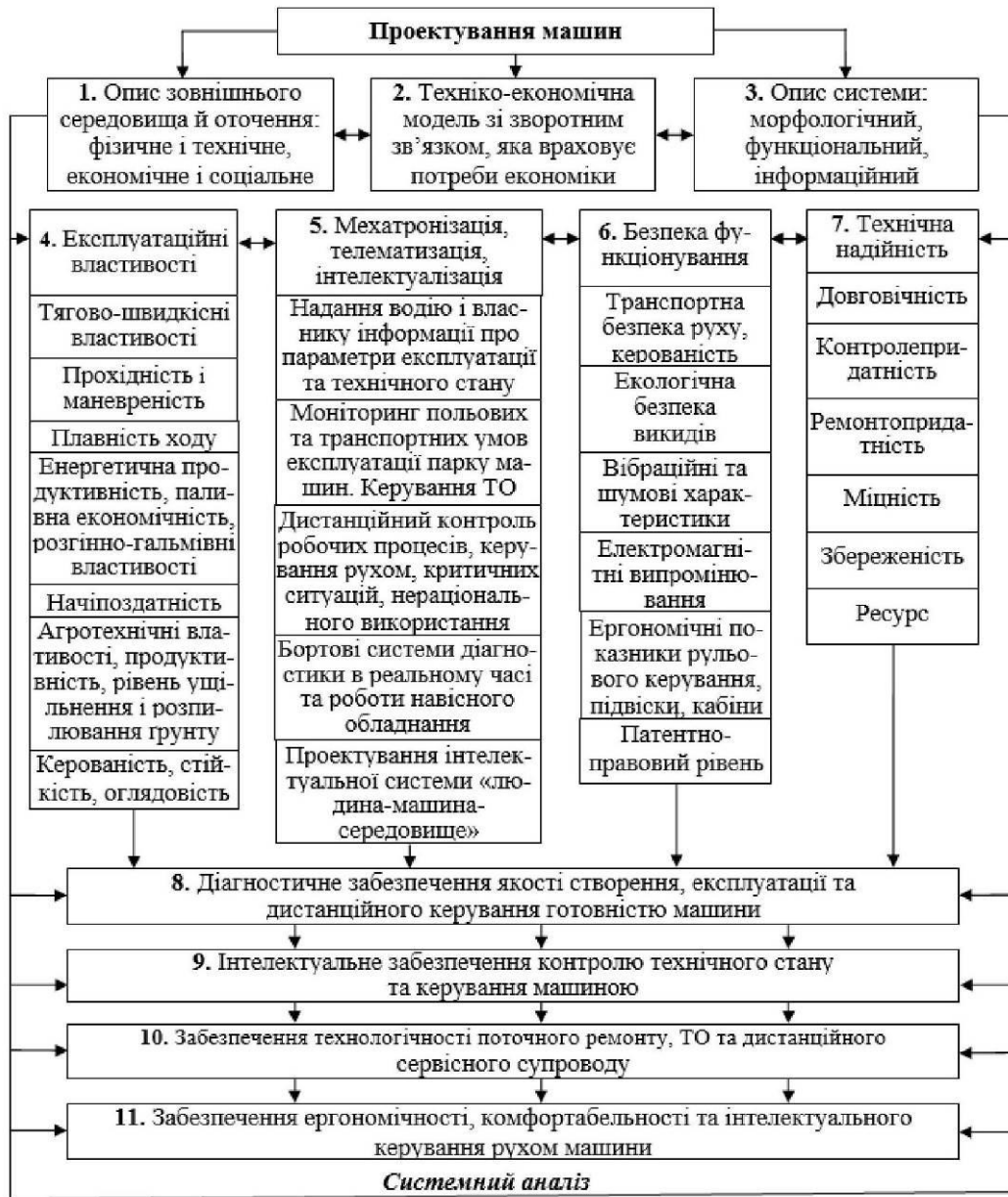
Рис. 1 – Структурна схема основних завдань і системного підходу до їх розв'язання при проектуванні машин [2]
