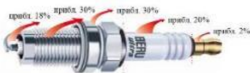
Рис. 2 - Шлях перенесення тепла свічки запалювання
