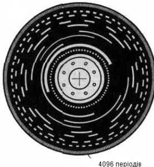
Рисунок 4 - Приклад кодованого круга в електронному теодоліті
