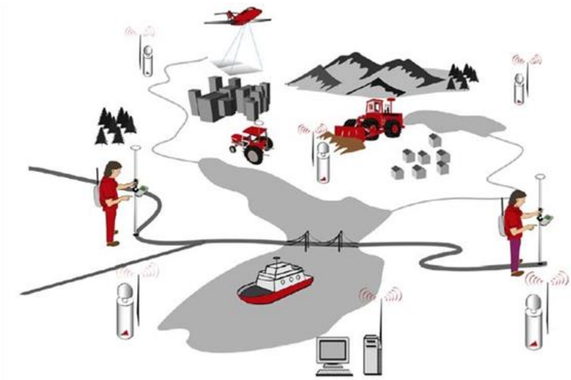
Рисунок 28 – Схема роботи мережі базових станцій
