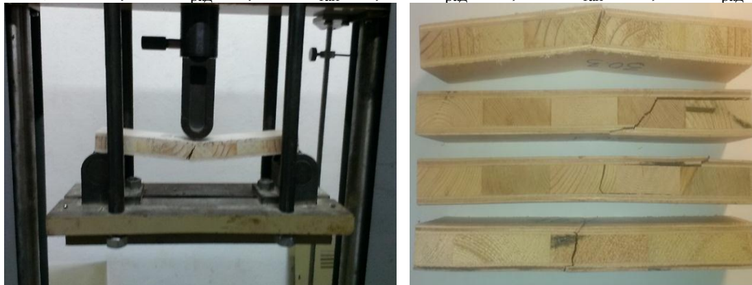
Рисунок 1 – Випробування зразків столярної плити із ВЖД сосни
