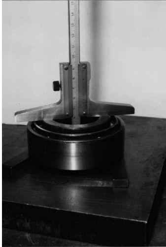
Рисунок 8 – Контроль монтажної висоти за допомогою штангенглибиноміру
