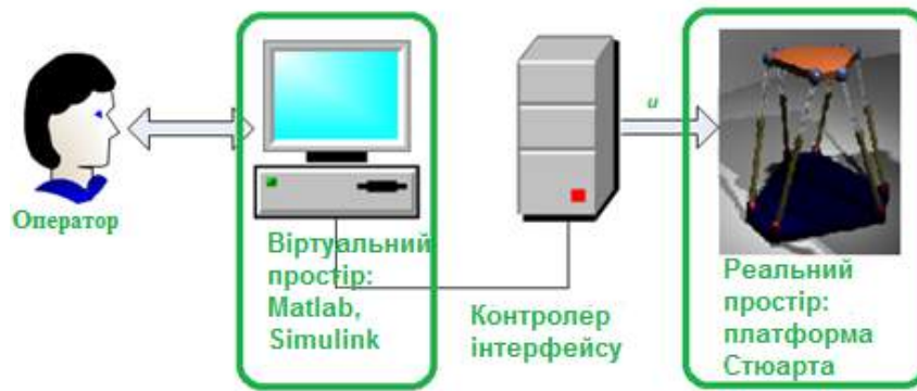
Рисунок 1 – Комп’ютерно – інтегрована система керування рухами платформи Стюарта
