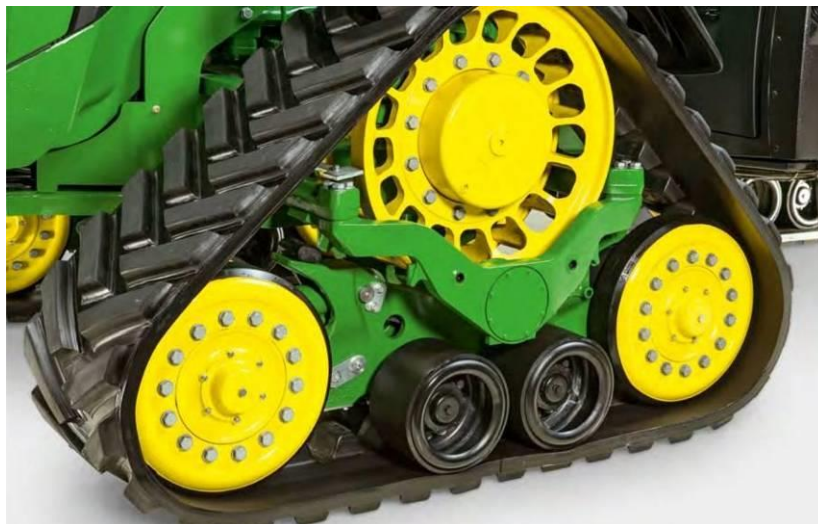
Рис. 4.11 – Гусеничний рушій з трикутним обводом
