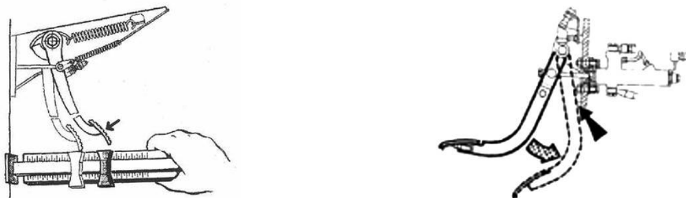
Рис. 5.10 – Схема перевірки вільного ходу педалі
