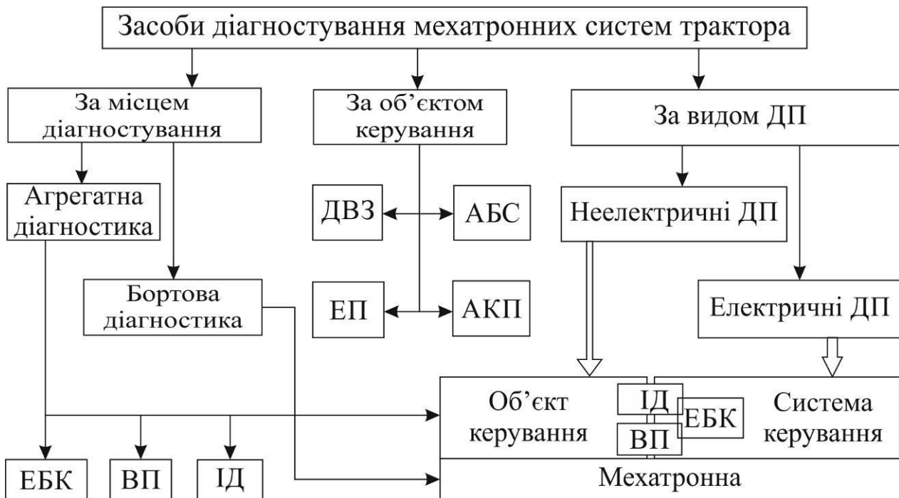
Рис. 10.5 – Засоби й об'єкти діагностики мехатронних систем:
