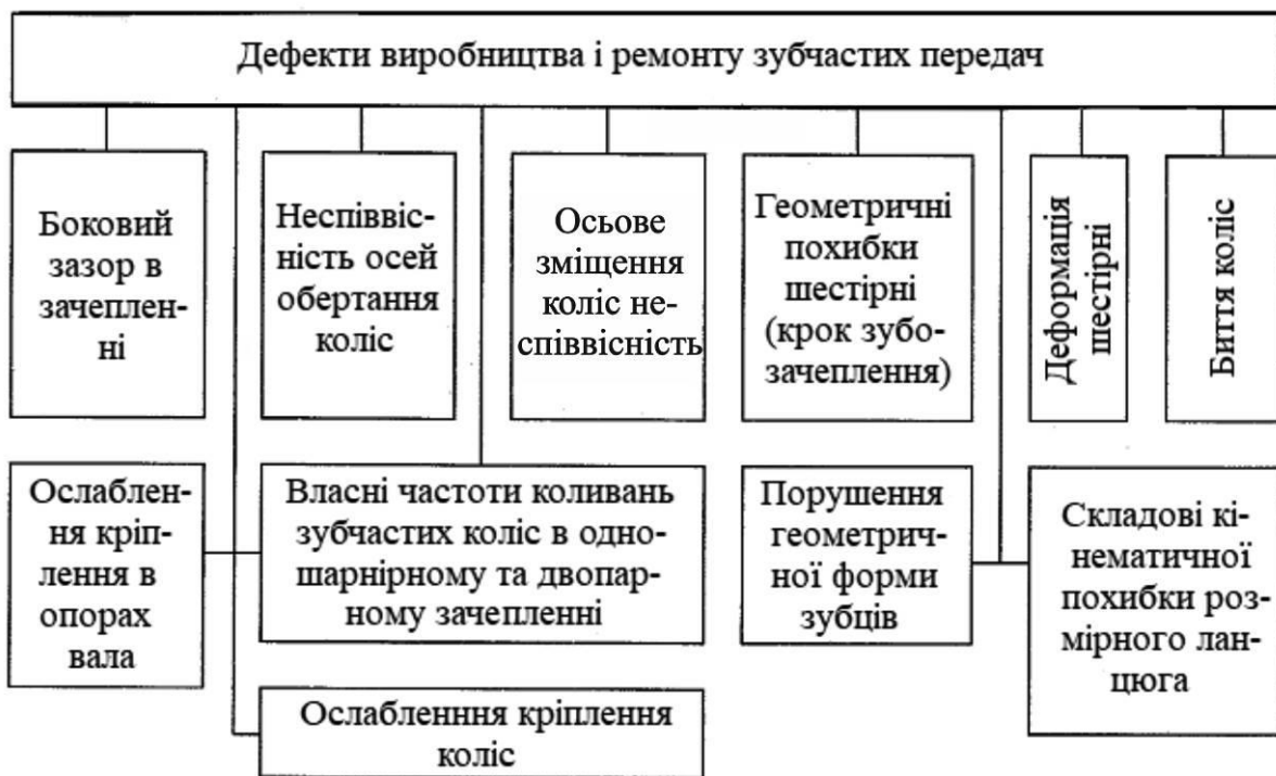
Рис. 5.5 – Основні комплексні дефекти зубчастих передач
