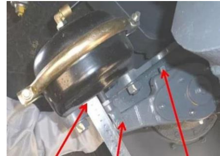
Рис. 2.18 – Перевірка ходу штока гальмівної камери
