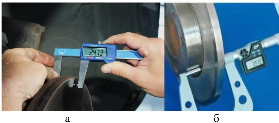
Рис. 2.17 – Вимірювання товщини диска за допомогою штангенциркуля (а) та мікрометра (б)
