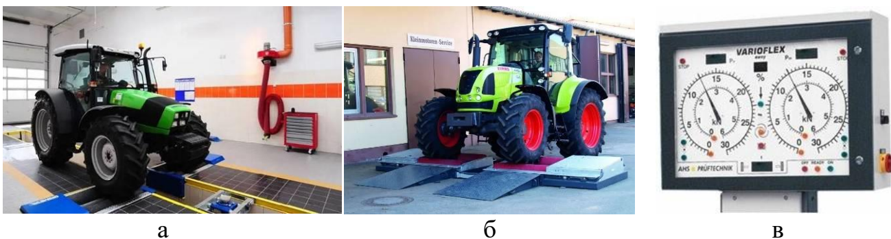
Рис. 2.13 – Роликовий стенд MBT 6000 (а, б) та аналоговий дисплей з результатами тестування (в)
