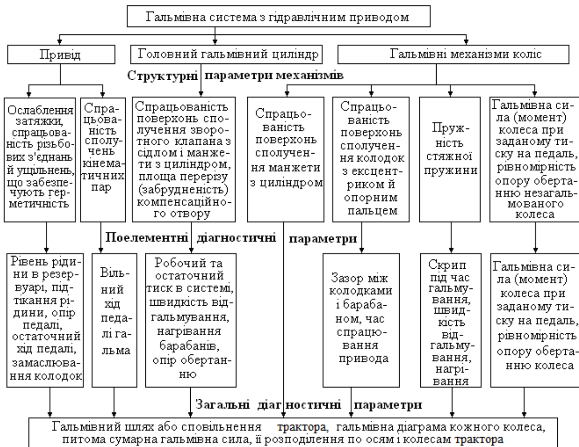
Рис. 2.8 – Діагностичні параметри гальмівної системи
