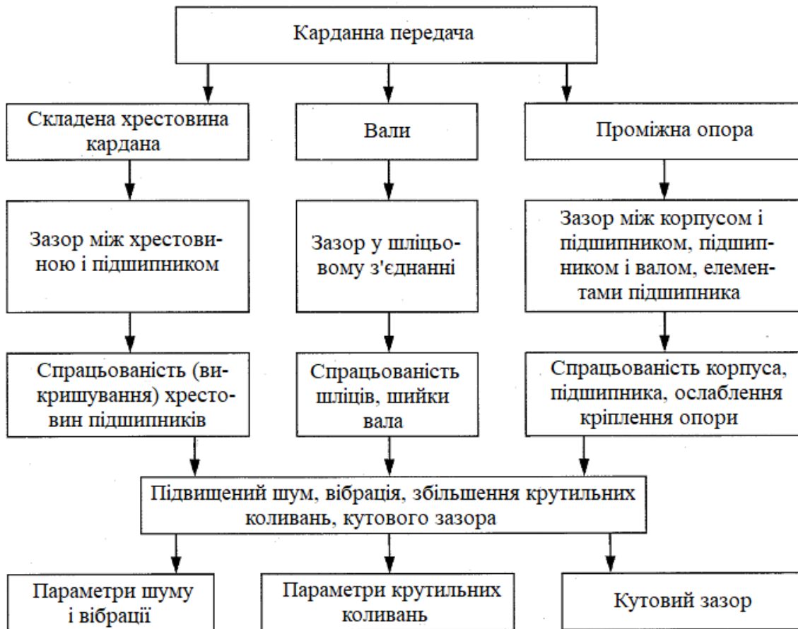
Рис. 5.6 – Блок-схема структурно-наслідкових зв'язків елементів карданної передачі
