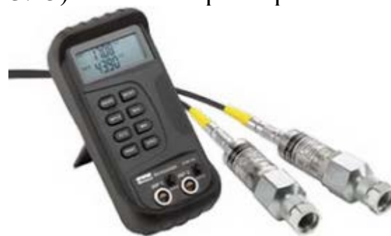
Рис. 3.25. Цифровий прилад Serviceman і датчики температури
