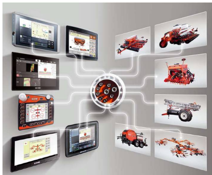
Рис. 6.4. Термінал ISOBUS керує всіма машинами сільськогосподарського виробництва
