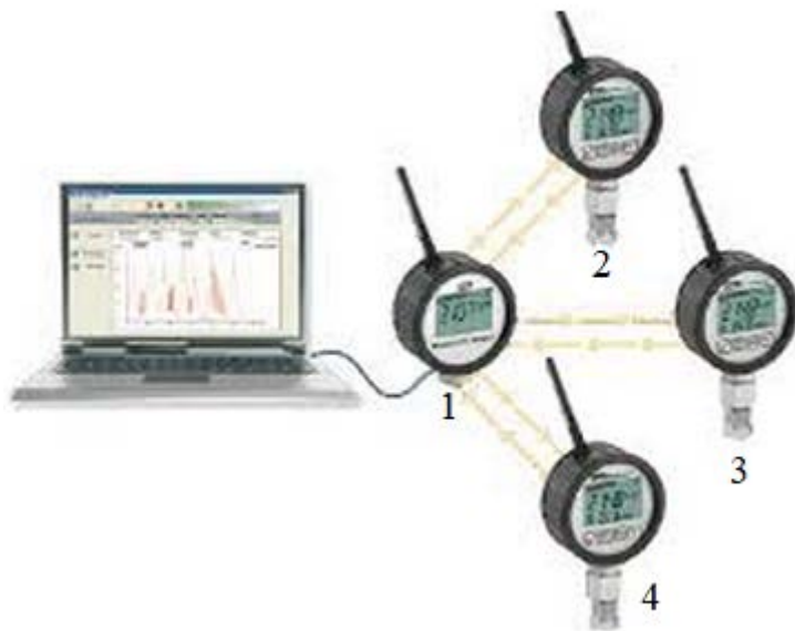
Рис. 3.24. Схема передачі даних при моніторингу у гідросистемі на основі ServiceJunior wireless
