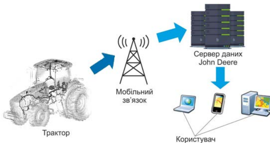
Рис. 6.11. Принципи роботи телематичної системи JDLink та операційного центру
