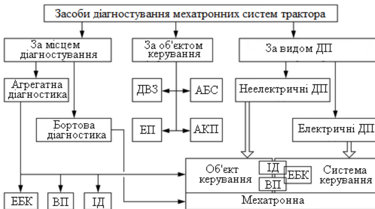
Рис. 8.6. Засоби й об'єкти діагностики мехатронних систем:
