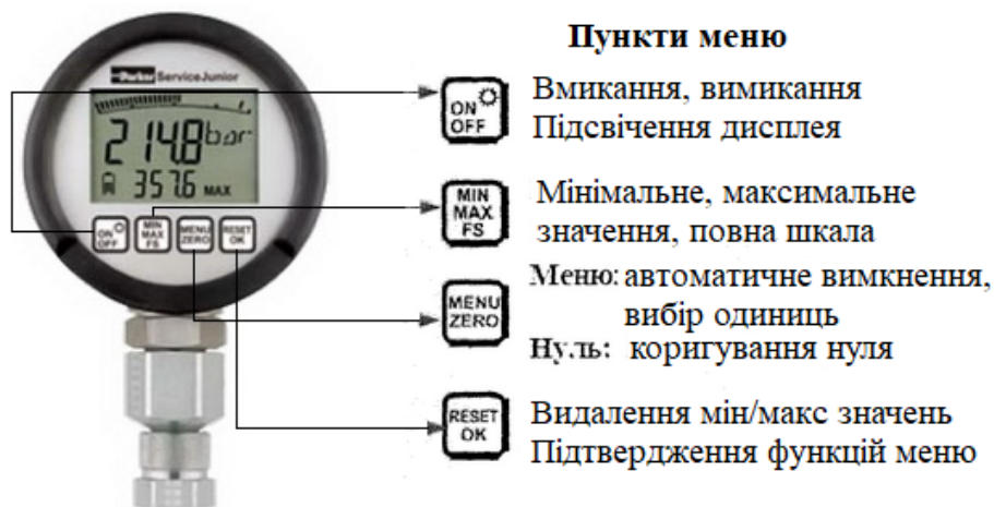
Рис. 3.22. Цифровий манометр ServiceJunior з умовними позначеннями
