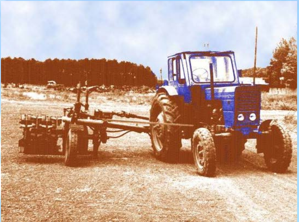
Рис. 5 Напівначіпний розкидач органічних добрив із куп в кругову
