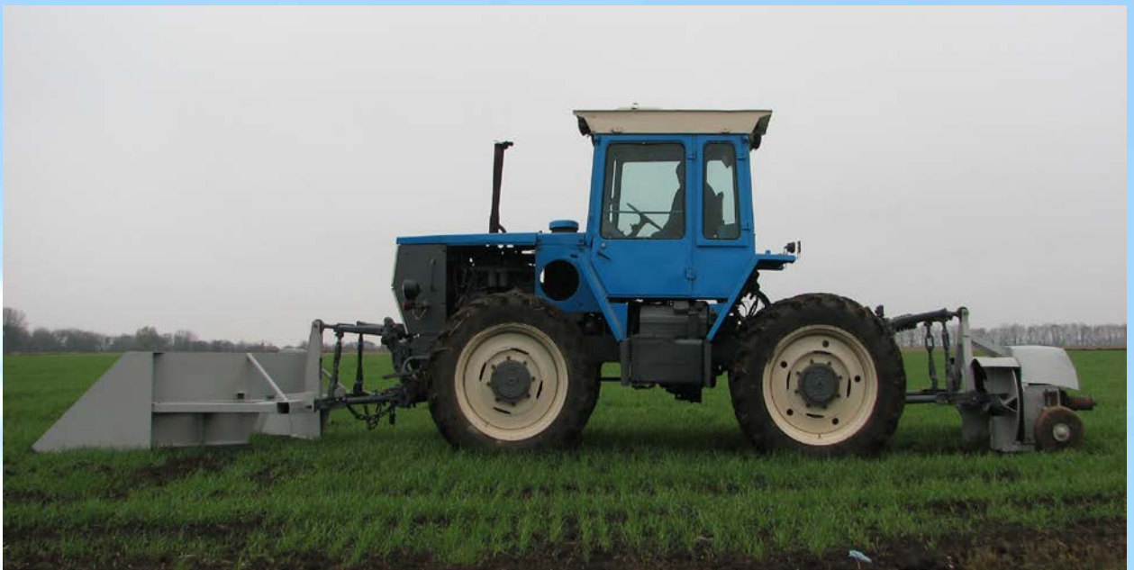
Рис. 4 Валкувач з подільником куч добрив: А — вид спереду; Б — вид збоку;
