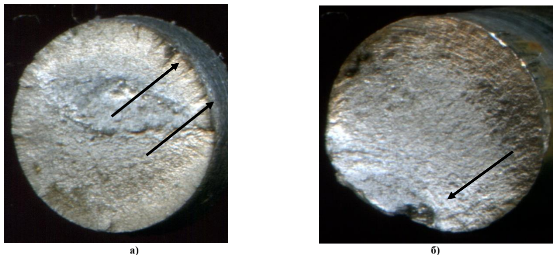
Рис.4 – Поверхность излома гладкого образца после 0,67 \times 10^5 циклов под нагрузкой 0,32 \sigma_{0,2} (а) и упрочненного дробеструйной обработкой после 0,95 \times 10^5 циклов под нагрузкой 0,45 \sigma_{0,2} (б)
