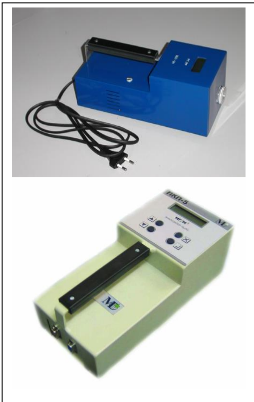
Рис. 7 - Вимірювач масової концентрації пилу ІКП-4 (вгорі) і Аналізатор пилу "ІКП-5" (див. нижче)
