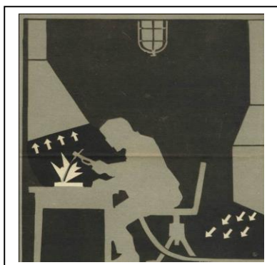
Рис. 17 - Вентиляція у виробничому приміщенні: а) припливна; б) витяжна
