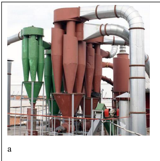
Рис.20 - Пиловловлювачі типу «Циклон»: а) зовнішній вигляд; б) схема роботи
