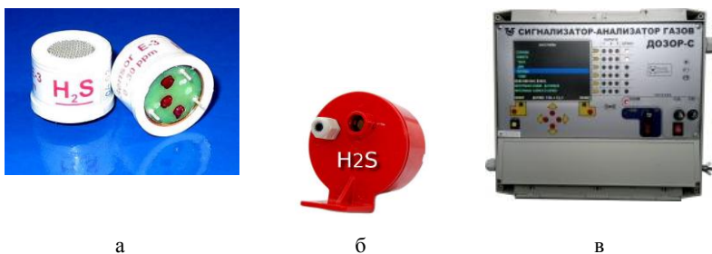
Рис. Сенсорні засоби: для визначення наявності сірководню в повітрі (а), вимірювальний перетворювач цифровий (ИПЦ-Н 2 S) (б) та газосигналізатор «Дозор-С» (в)
