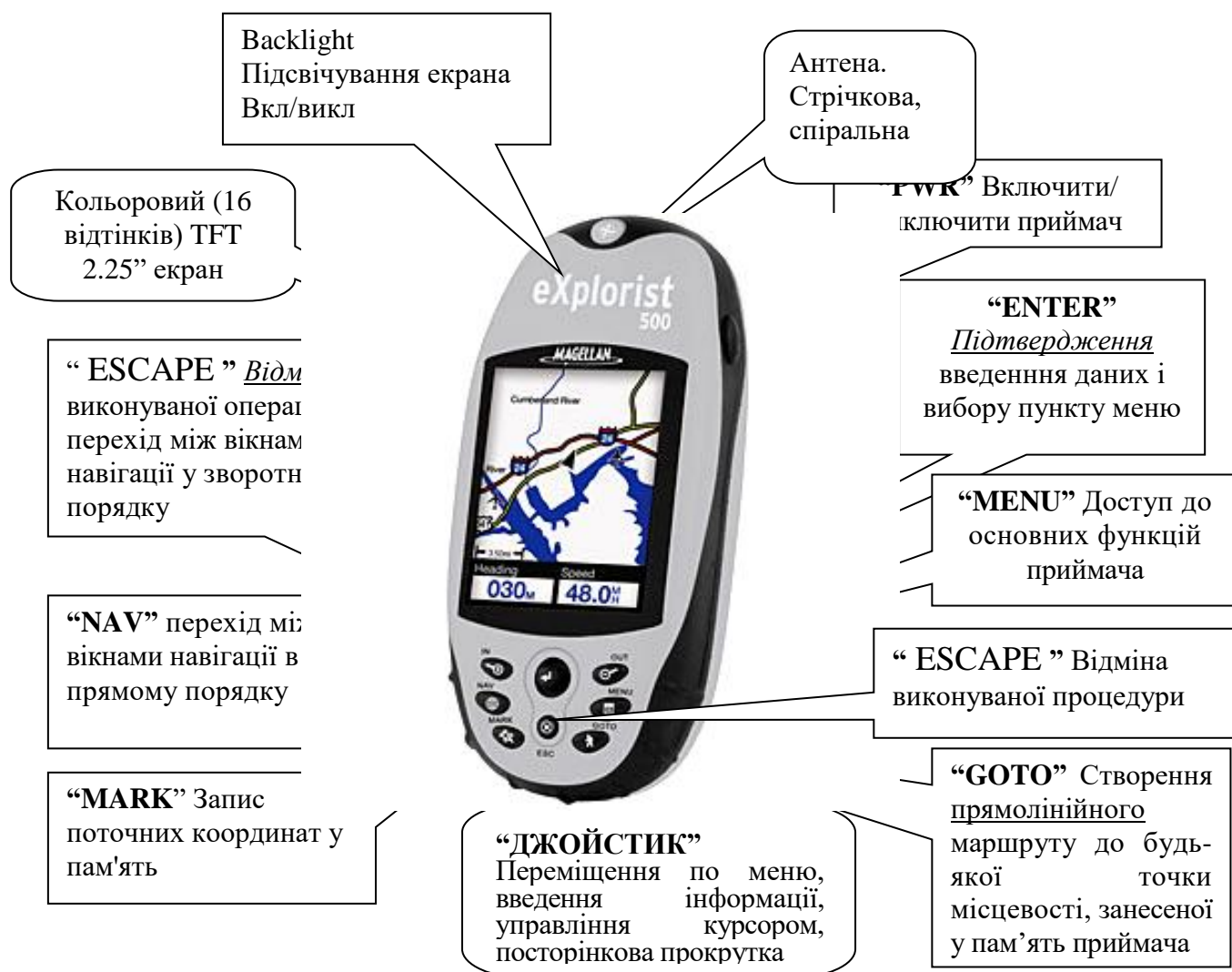
Рис. 1. Лицева панель і функціональне призначення клавіш
