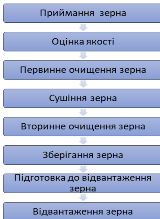
Рис. 2.5 - Послідовність основних технологічних операцій на елеваторі
