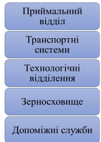
Рис. 2.1 - Основні складові частини елеватора
