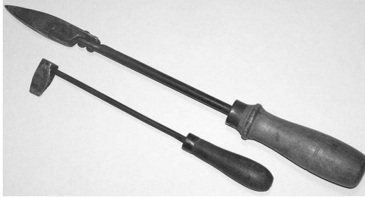
Рис.7 Паяльник періодичного нагріву: а – кутовий; б – прямий
