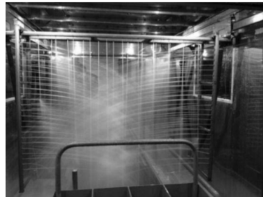
Рис. 6 Однокамерна установка для очищення: 1 – підвідний патрубок; 2 – приєднувальний штуцер; 4 – перфорована труба; 5 – насадка; 6 – візок
