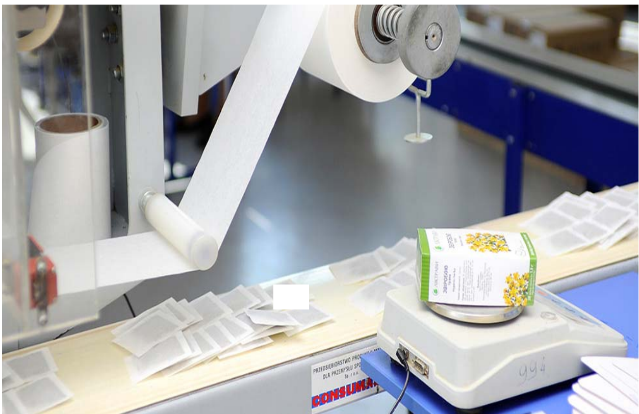
Рис. 4.6. Лінія фасування у фільтр-пакети
