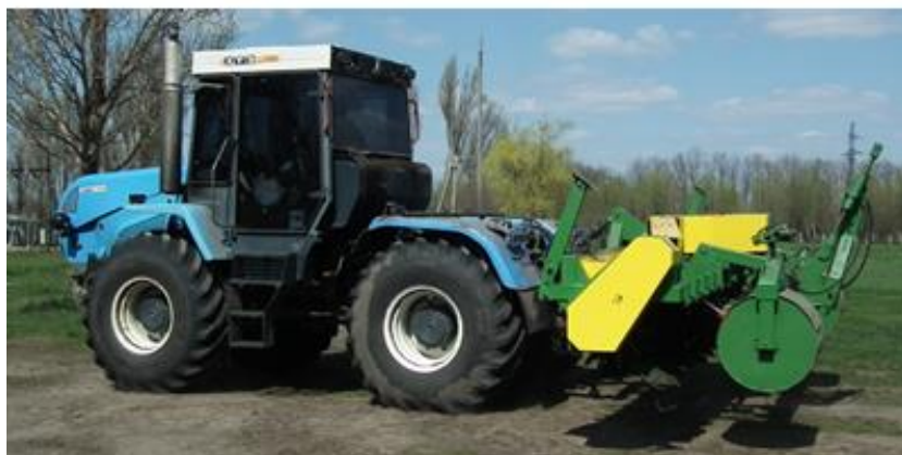
Рис. 1. Культиватор роторний розпушально-сепаруючий (стратифікатор) в агрегаті з трактором ХТЗ-17221
