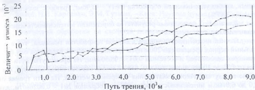
Рис. 1. Зависимость величины износа от пути трения в период приработки покрытий, нанесенных: 1 — без упрочняющей механической обработки; 2 — с упрочняющей механической обработкой.
