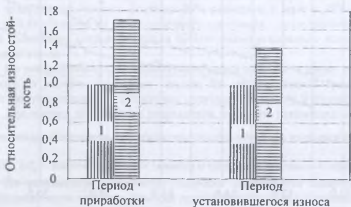
Рис. 3. Относительная износостойкость покрытий нанесенных: 1 – без упрочняющей механической обработки; 2 – с упрочняющей механической обработкой.
