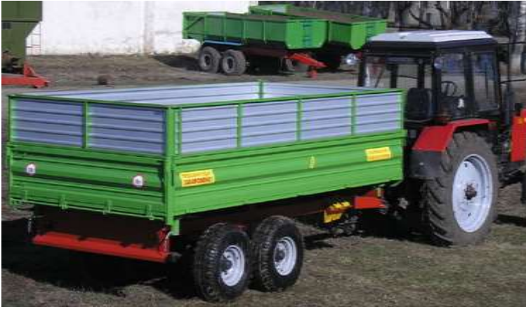
Рис. 1. Тракторный самосвальный прицеп ТСП-10 с трехсторонней разгрузкой к тракторам МТЗ-82, грузоподъемностью 8 т и некоторые виды гнутых профилей, применяющихся в его конструкции
