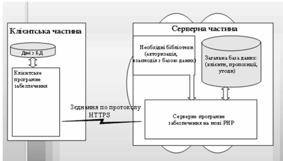
Рис.2-Взаємодія між сервером та клієнтом на основі протоколу https
