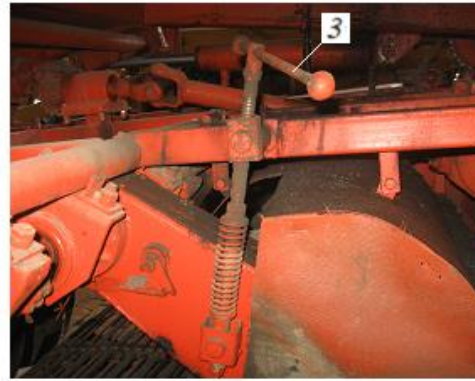
Рис. 16. Регулювання положення середнього шнека елеваторно-шнекового очисника:
