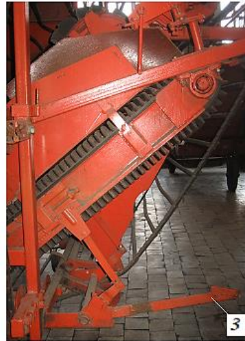
Рис. 18. Регулювання кута встановлення основної і додаткової пальчастих гірок:
