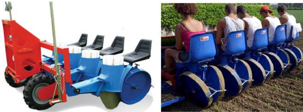
Рис. 19. Розсадосадильна машина F-MAX
