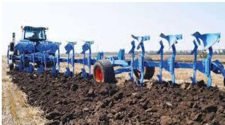
Рис. 1. Начіпний оборотний плуг з гідравлічно регульованою шириною захвату Plus XMS-Vario
