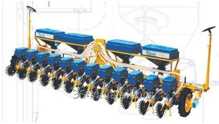
Рис. 17. Сівалка універсальна просапна точного висіву модель СТВТ-12/8М
