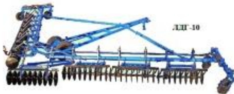
Рис. 3. Дисковий лушильник ЛДГ-10А
