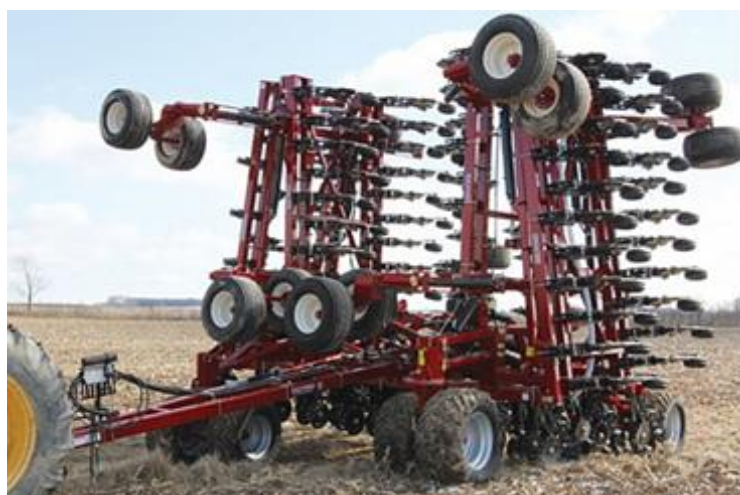
Рис. 16. Стерньова дискова сівалка SALFORD 580
