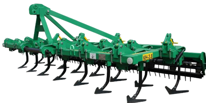
Рис. 5. Культиватор суцільний КН-3,8
