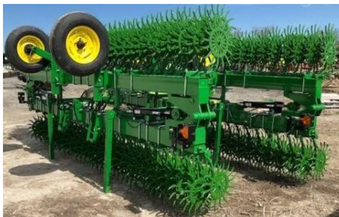
Рис. 12. Ротаційна Борона John Deere 400 (США)
