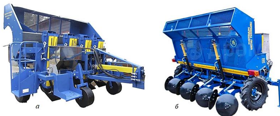
Рис. 1. Загальний вигляд картоплесаджалки КСМ-4: а – вигляд спереду; б – вигляд ззаду
